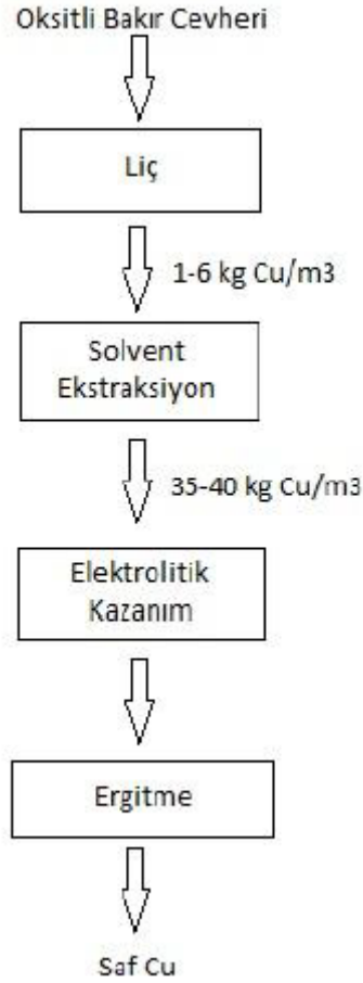
Şekil 1. Hidrometalurjik bakır (Cu) üretim diyagramı
