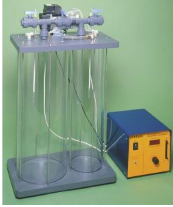
Şekil 1- Mükemmel gazın genişlemesi deney düzeneği
