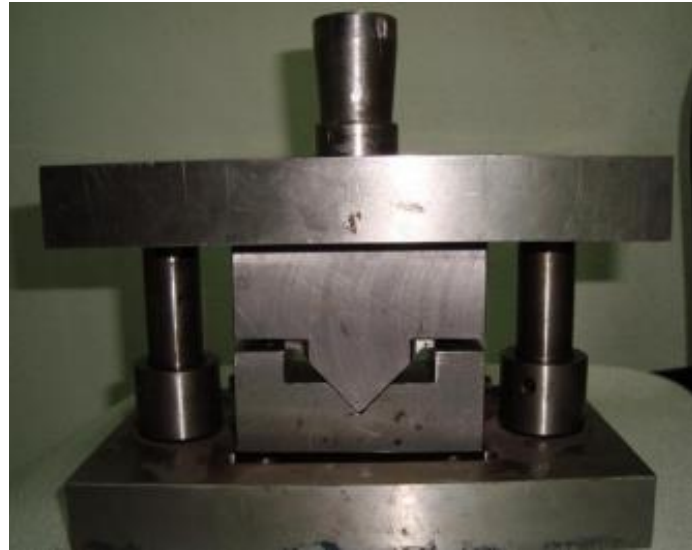
Şekil 7. Örnek bir V bükme kalıbı [5]
