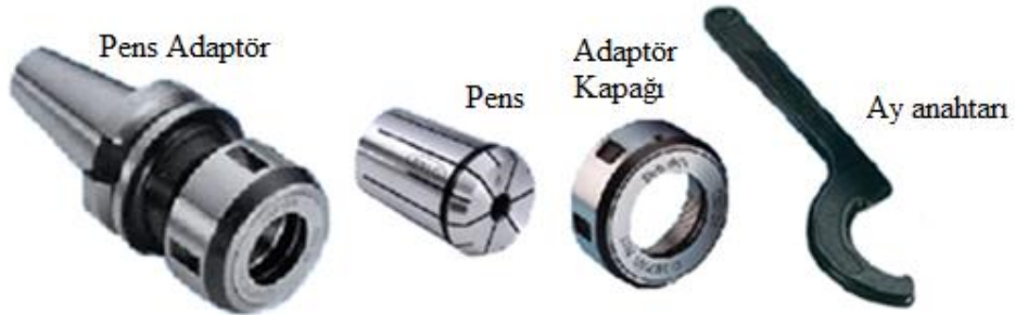
Şekil 21: Freze Çakılarının Penslerle Bağlanması [1]
