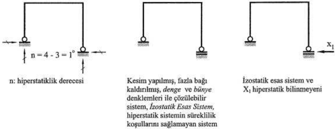
Şekil 5.10 Birinci dereceden hiperstatik bir sistem, izostatik bir esas sistem ve hiperstatik bilinmeyen
