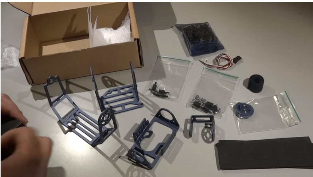
Şekil 2.7. 2-eksenli gimbal demonte hali
