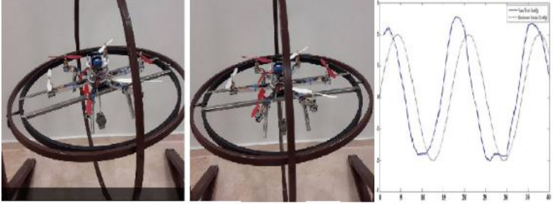
Şekil 4.18. Döner kanat İHA'nın dönme hareketi ve test sonucu.
